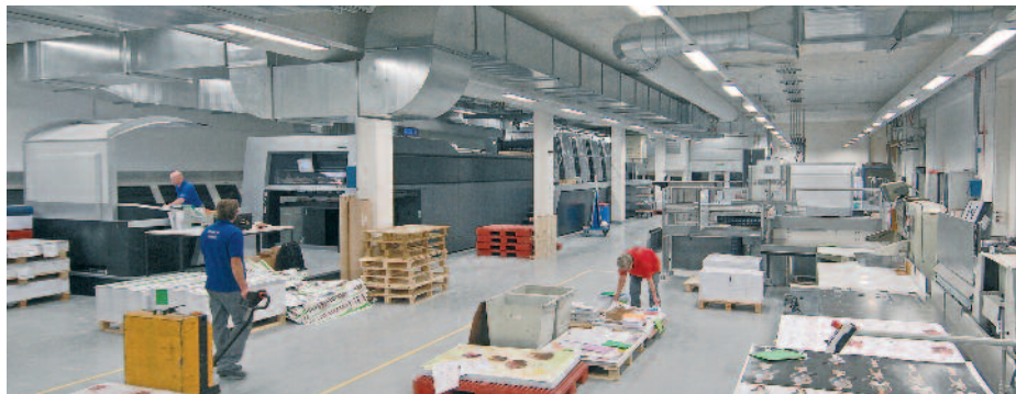
Mit der Speedmaster XL 145-Fünffarben plus Lackierwerk – die erste Maschine dieser Art in der Schweiz – produziert Schläefli & Maurer eine zunehmende Vielfalt an Produkten im hochwertigen Akzidenzdruck.
