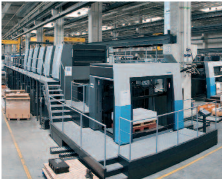
Seit Anfang 2009 fertigt Heidelberg seine Grossformatmaschinen Speedmaster XL 145 und 145 in Serie. Für die Baureihe wurde in eine moderne
